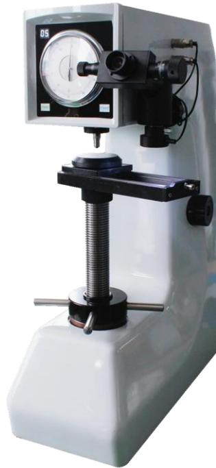
**HBRVD-187.5 电动布洛维硬度计是可进行布氏,洛氏,维氏三种硬度测试,七级试验力的多用途多功能硬度计,能满足用户多种硬度测试的要求。是一款高精度、高稳定性的硬度计,改进了机械结构,提高了稳定性。**
