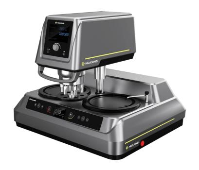
LMP-4S 型自动磨抛机为双盘台式机,是中心力加压和单点加压的一体机,是依据国际标准,采用国际先进工艺技术制造的新一代高精度、制样过程自动化的研抛光设备。具备磨抛盘旋转方向可任意选择、磨抛盘可快速更换;多试样夹试器和气动单点加载等功能。本机采用了先进的微处理器控制系统,使得磨抛盘、磨抛头的转速实现无级可调,制样压力、时间设定直观、便捷。只需更换磨抛盘或者砂纸和织物即可完成磨、抛工序的操作。从而使本机展现了更加广泛的应用性。具有转动平稳、安全可靠、噪音低及采用铸铝底座增加了磨抛的刚性等特点。
